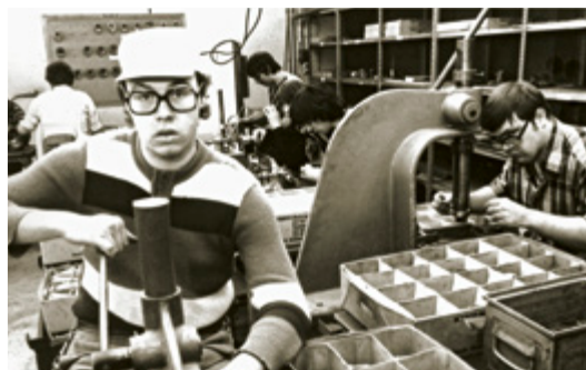
>>>> Erste Produktionen in der neuen Werkstatt in Berkhöpen, Firma Wabco, Montage Bremsventilgehäuse
